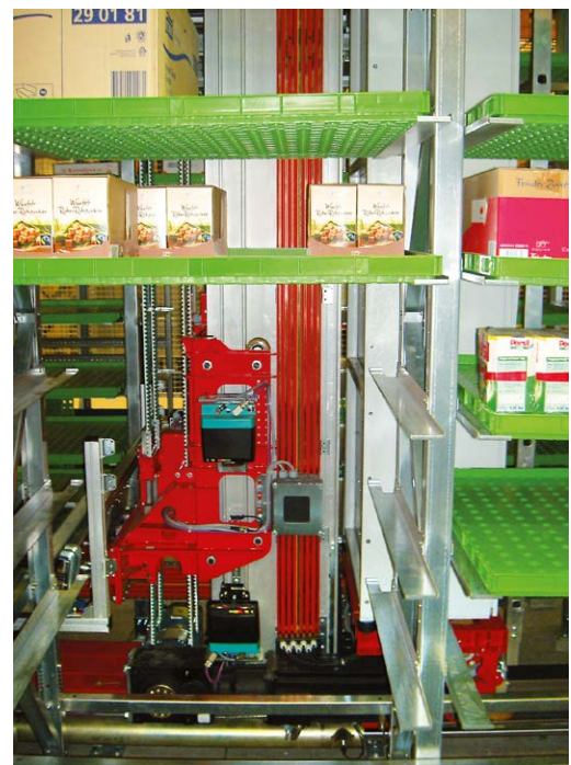
Anwendung von Mast-Stromschiene (7-Polig Pro-Ductorsystem) auf Mini-load
