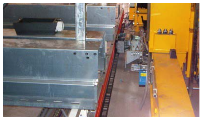
Anwendung eines 10-Poligen Pro-Ductorsystems mit Codierband
