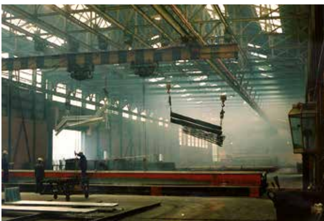
Voeding en besturing van bovenloopkranen in een verzinkkerij
