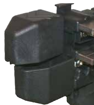
L'assemblage à queue d'aronde facilite la fixation rapide des sabots coulissants. Le marquage simplifie l'inspection visuelle.
