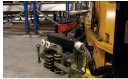
Met behulp van sensoren wordt de stroomvoorziening naar de stroomafnemer uitgeschakeld op het moment dat deze de rails verlaat
