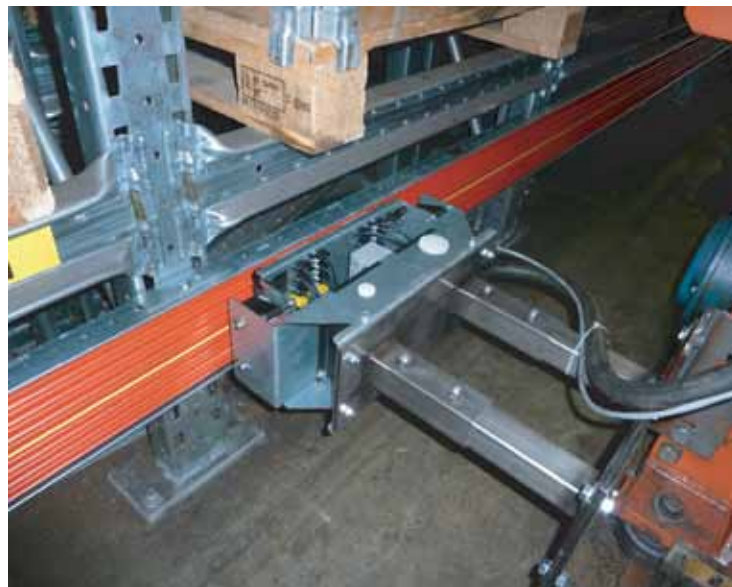
Aangestuurd vanuit de onderhoudsafdeling wordt er jaarlijks geïnvesteerd in vernieuwingen. Dit jaar werden de stroomrails van de kranen van het automatische hoogbouwmagazijn vervangen. Links een zicht op het oude systeem (Multiconductor), rechts het nieuwe (Pro-Ductor).
