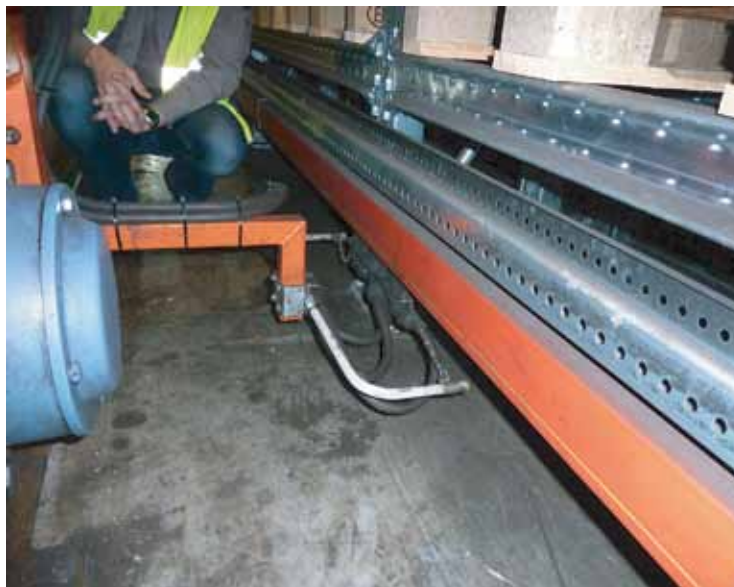
Aangestuurd vanuit de onderhoudsafdeling wordt er jaarlijks geïnvesteerd in vernieuwingen. Dit jaar werden de stroomrails van de kranen van het automatische hoogbouwmagazijn vervangen. Links een zicht op het oude systeem (Multiconductor), rechts het nieuwe (Pro-Ductor).
