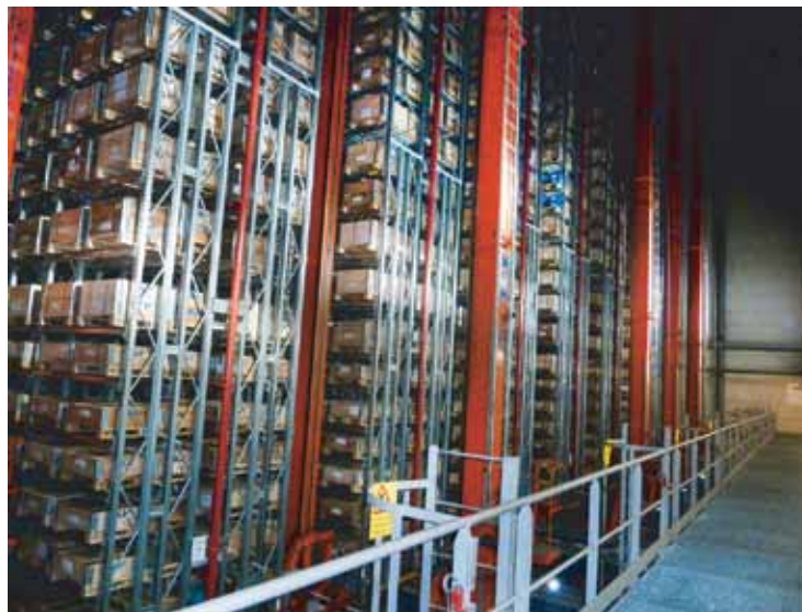
Het automatisch magazijn van SKF Logistics Services Belgium in Tongeren omvat 60.000 palletplaatsen verdeeld over zeven gangen en bediend door evenveel automatische kranen.
