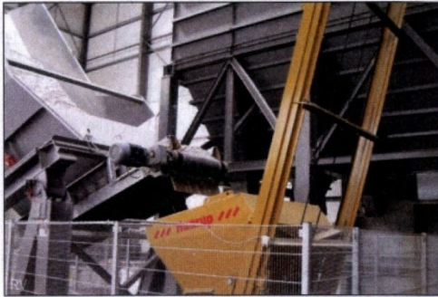
Deux nouveaux malaxeurs de béton ont été installés pour augmenter la production de plaques de béton. En parallèle, le trajet du convoyeur aérien a été adapté.
