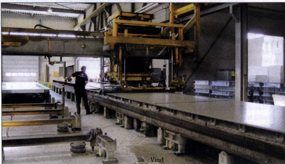
L'usine de Bree fonctionne avec des lignes de production longues de 150 m, constituées de tables fixes d'une longueur de 30 m chacune
